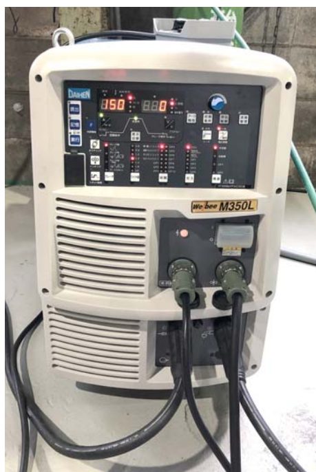
CO 2 溶接 WB-350L ダイヘン製(2019年11月導入)
